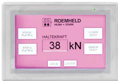
Kraftsensor „FES“ zur Luftspaltmessung und dauerhaften Überwachung und Anzeige der Haltekraft.
