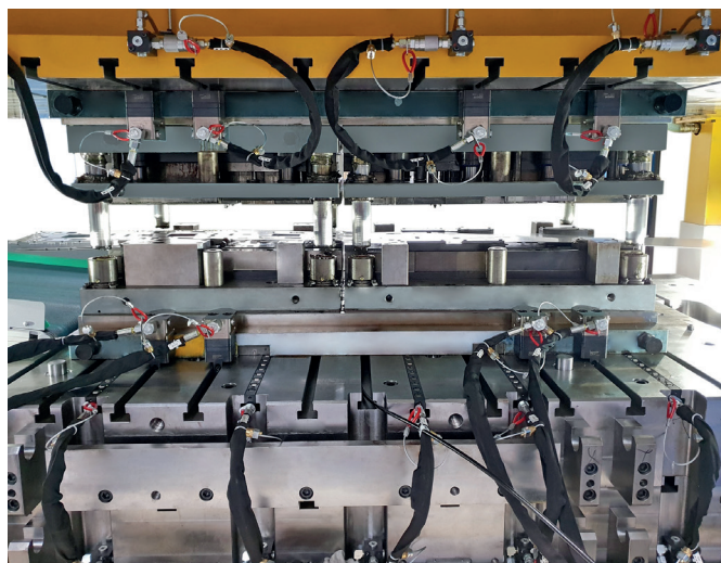
Cabeza de sujeción por introducción con pie para ranura en T en la mesa inferior y superior de la prensa
