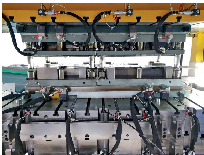
Tête de serrage avec support en T sur la table et le coulisseau de presse
