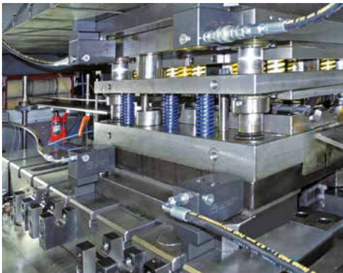
Einschubspanner mit T-Nutenfuß in Pressentisch und Stößel, Rollenleisten und Tragkonsolen für den Werkzeugeinschub.
