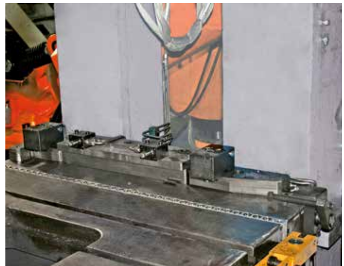
Spannkopf separat auf Leisten montiert, Kugelleisten im Pressentisch, Tragkonsolen davor. Blockzylinder und Schwenkspanner für die Positionierung
