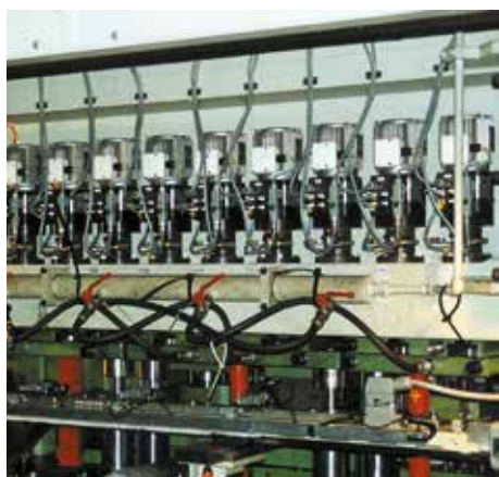
Utilización de elementos de sujeción giratorios a tracción electromecánicos en una prensa escalonada
