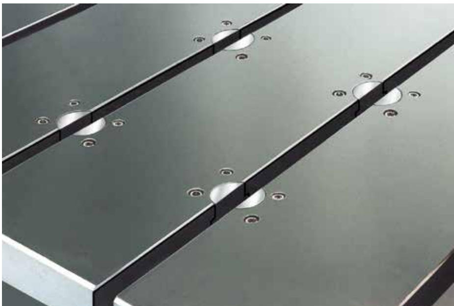
Elementos de sujeción a tracción con ranura en T montados en la mesa inferior
